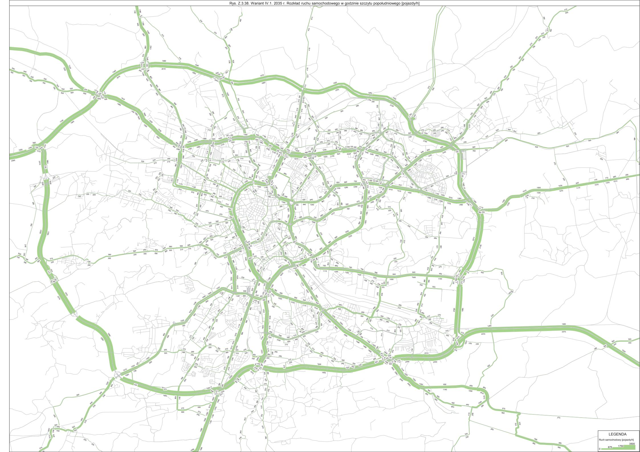
Rys. Z.3.39. Wariant IV.2, 2035 r. Rozkład ruchu samochodowego w godzinie szczytu popołudniowego [pojazdy/h]
