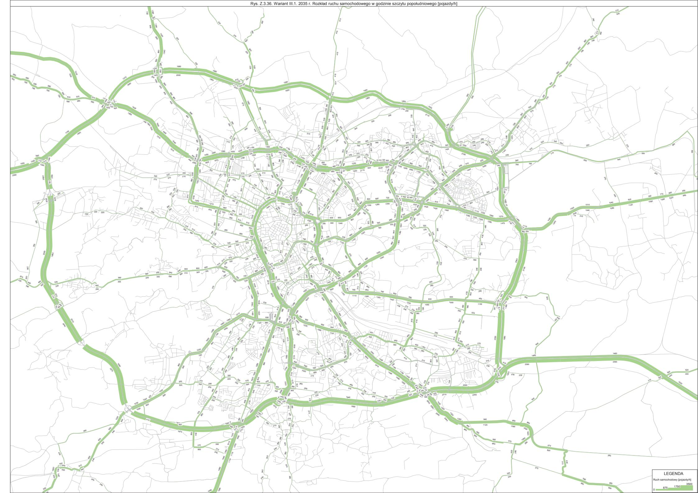
Rys. Z.3.37. Wariant III.2. 2035 r. Rozkład ruchu samochodowego w godzinie szczytu popołudniowego [pojazdy/h]
